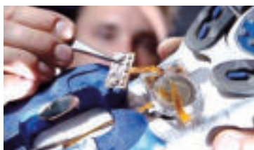
Fig. 1.9 Mikroprocesori i ndërtuar te këto patika për vrapim e njehton shtypjen ndërmjet këmbëve të vrapuesit dhe mbështetësen pesë milionë herë në sekondë dhe rregullisht ndryshon pozitën e jastëkëve për të fituar në komoditet më të madh.
